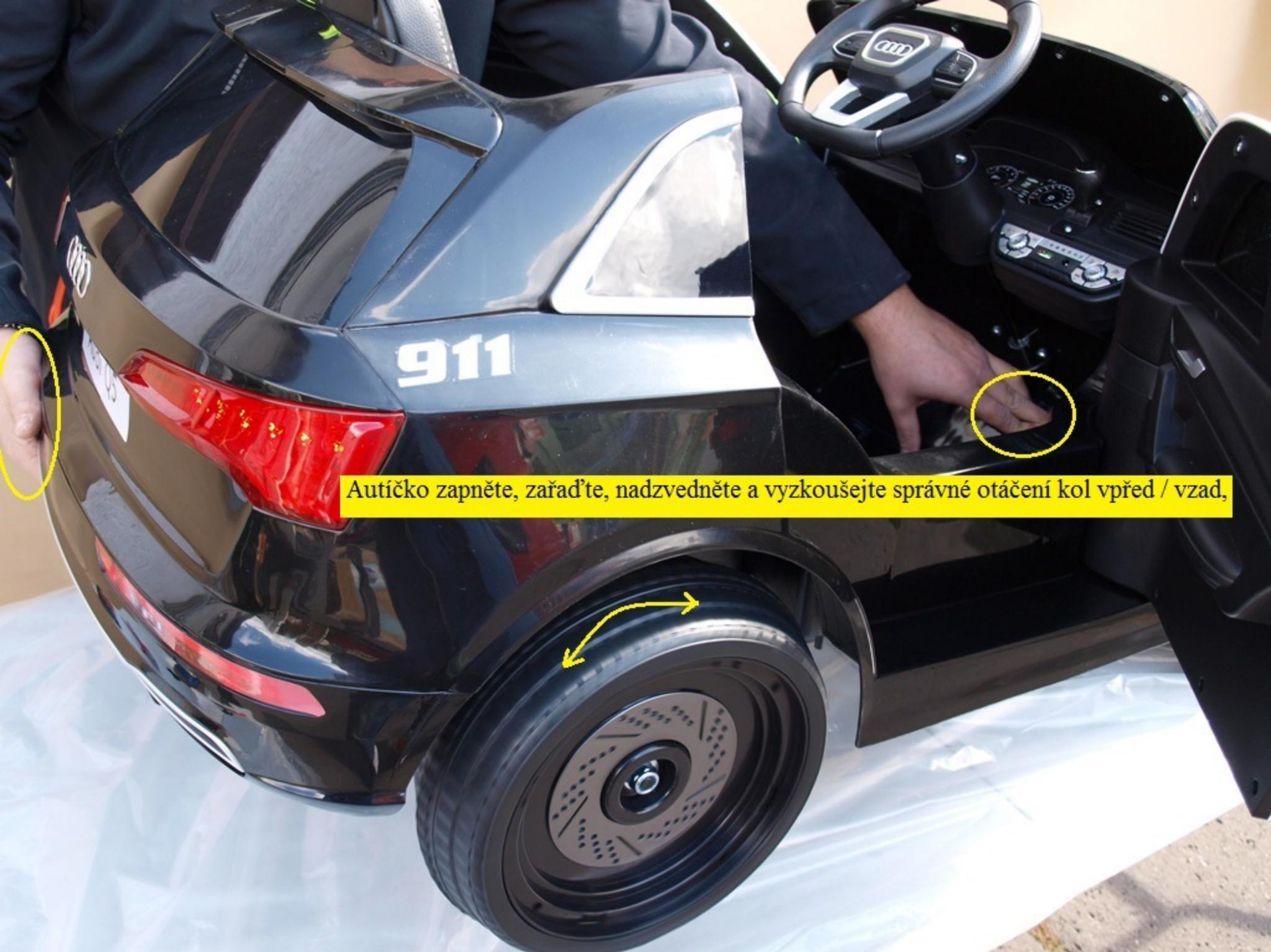
Autíčko zapněte, zařaďte, nadzvedněte a vyzkoušejte správné otáčení kol vpřed / vzad,
