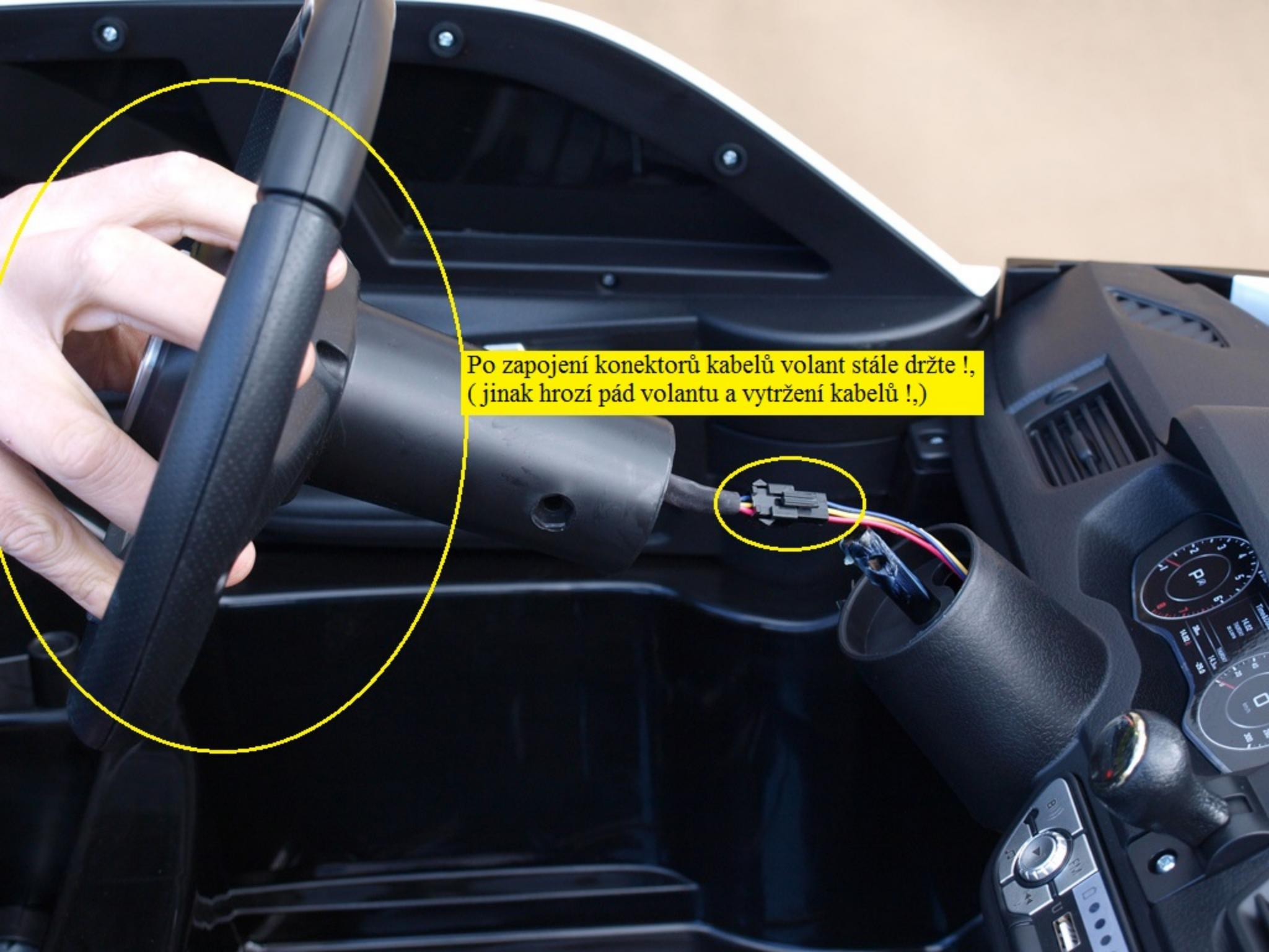
Po zapojení konektorů kabelů volant stále držte !,
