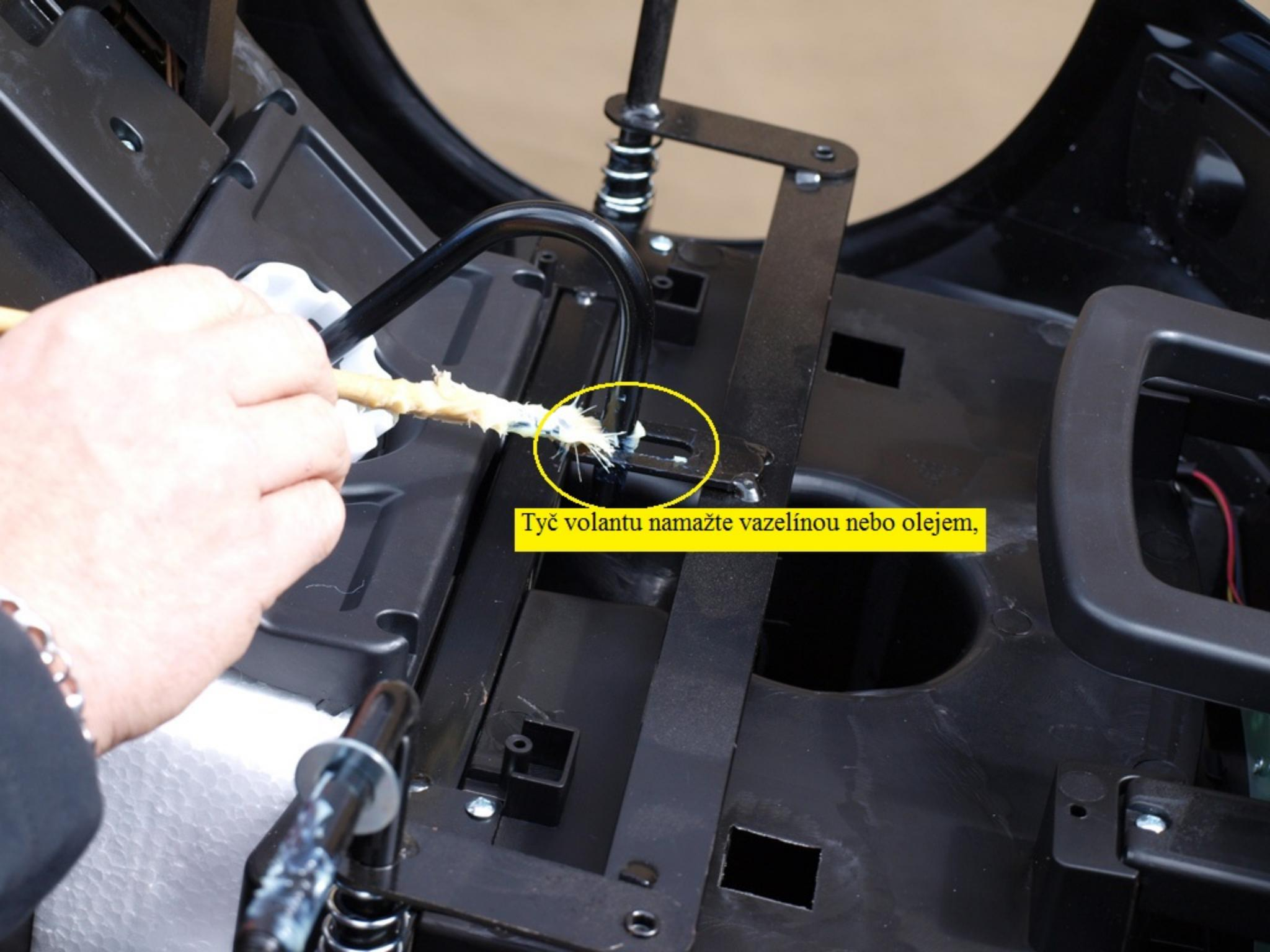
Tyč volantu namažte vazelinou nebo olejem,
