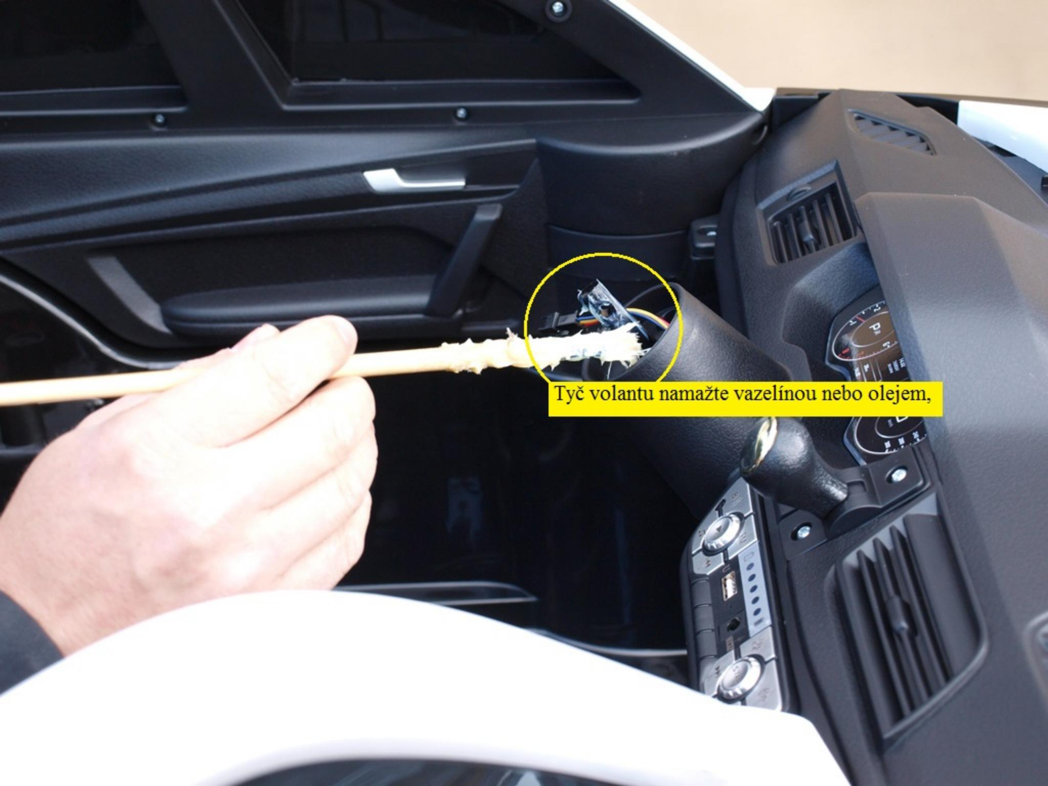
Tyč volantu namažte vazelinou nebo olejem,
